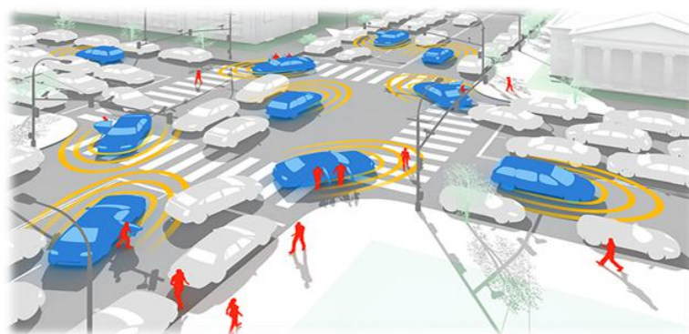
图 2 汽车雷达干扰场景的示意图
